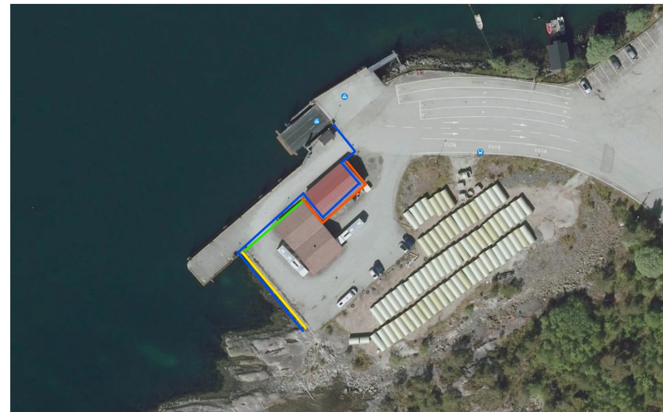
Figur 5-17 Utklippet syner estimert grunntilhøve i dagens situasjon. Gul linje: Middels dårlig tørrmur, grønn: Relativt god tørrmur. Oransje: fylling. Blå: Sjøfront under kaikonstruksjonar.
