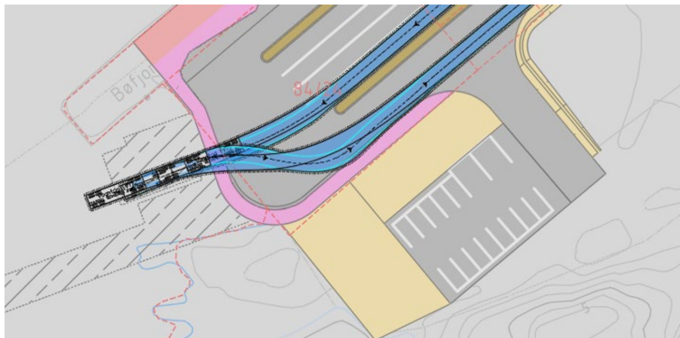
Figur 6-8 Kopling mellom kai og køyreareal er vesentleg del av å skape eit godt ferjekaiområde. Forslått løysing er vist i figur. Erfaringsmessig er det likevel slik at endeleg løysing kan avvike noko frå skissert løysing basert på vidare grunnundersøking, detaljprosjektering av kai og endelege budsjett. Området og løysingane er av den grunn ikkje låst i plan men er regulert med fleksibilitet innanfor o_ST. Det er i tillegg inkludert eit føresegnssområde #4 som konkretiserer overgangsområdet mellom kai og kaiområde. Sporinga i blått er for vogntog. Kjelde: Multiconsult.
